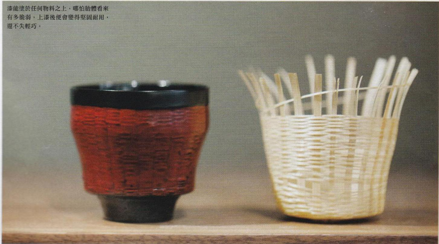
②用木、竹等材料製作胎體，把樹漆逐層塗在表面上，待乾透方可塗上另一層，形成防水膠膜。
